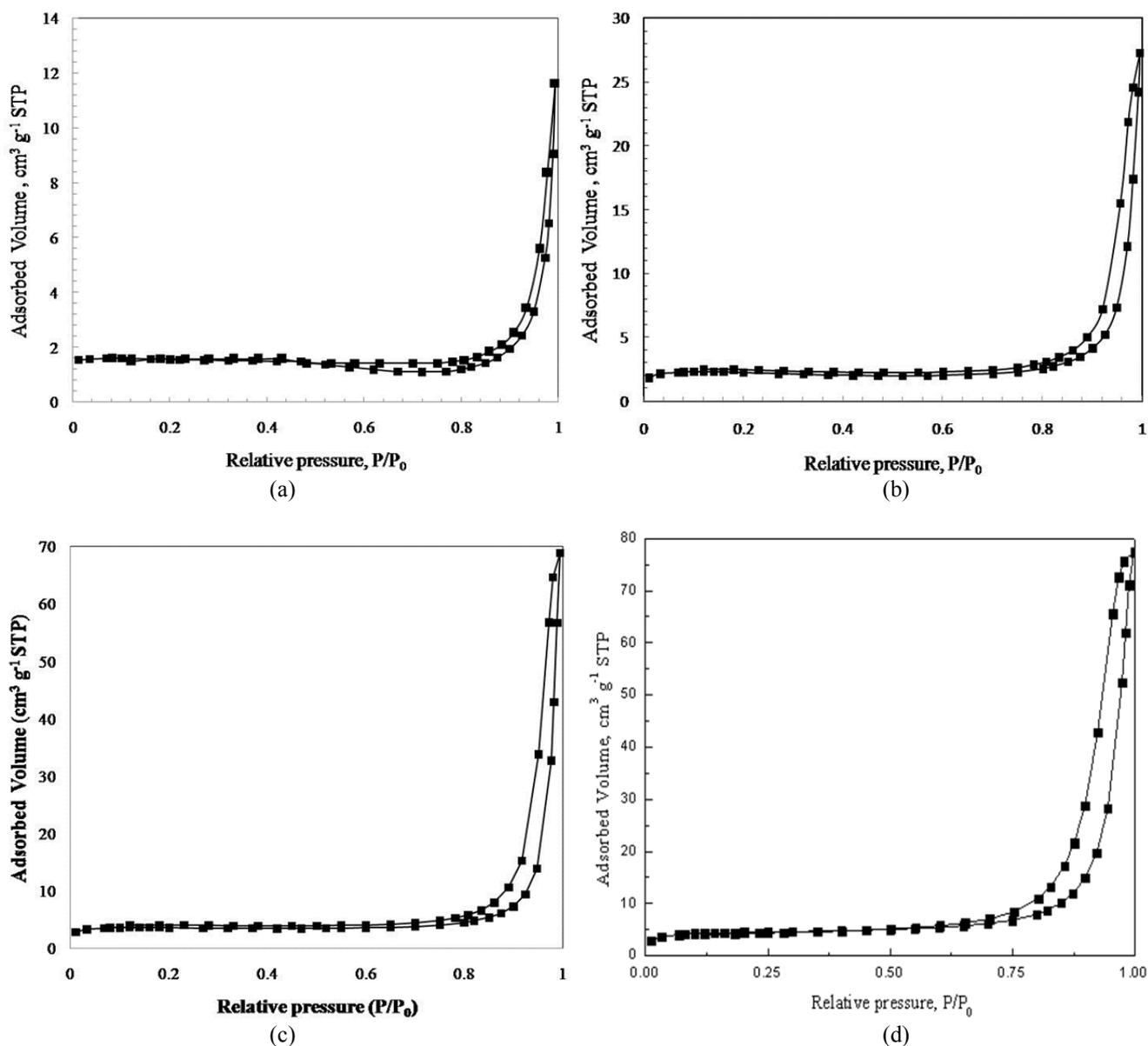
Fig. 4.  $N_2$  adsorption-desorption isotherms of TPFs: (a) PF, (b) 0.5%TPF, (c) 1%TPF, and (d) 2%TPF.
